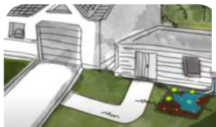
Massif d'infiltration (noues, jardin de pluie) pour la gestion des trop-pleins
